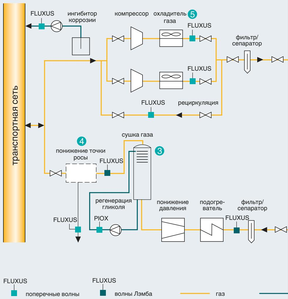
подачи в транспортную сеть следует соблюдать пределы по отношению к температуре конденсации. Поэтому газ при отборе следует сушить. Процесс сушки состоит из разных механических и термических этапов, на которых расходомер FLUXUS® G используется для измерения расхода газа, а расходомер FLUXUS® F для измерения расхода отделенной воды.
